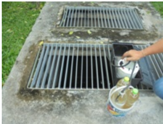
จุดเก็บน้ำทิ้งที่บ่อตรวจคุณภาพน้ำทิ้งก่อนปล่อยออกสู่ท่อระบายน้ำสาธารณะ
